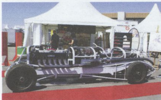
Karosserie: Auf diesem Bild ist der Rahmen und die Anordnung des Motors zu sehen. Beim Rangieren braucht es sehr viel Kraft.
