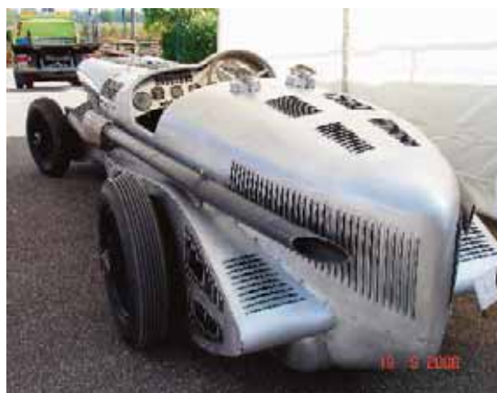
Auch hier war exakte Handarbeit gefragt. Jeder einzelne Lüftungsschlitz in den Aluminiumblechen hat eine andere Länge.
